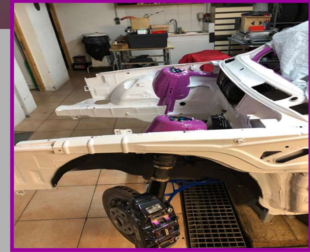
Modification du châssis, Kit grand angle Wisefab, Pompe de direction hydroélectrique, kit gros freins
