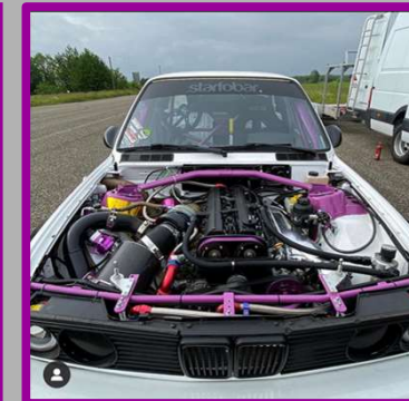
Gros turbo, Gestion moteur programmable, Véhicule 100% Ethanol
