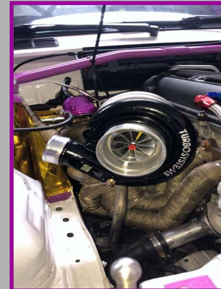
Gros turbo, Gestion moteur programmable, Véhicule 100% Ethanol
