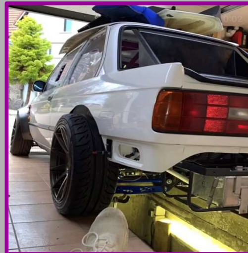
Train arrière E90, Pont soudé, Réservoir sur mesure
